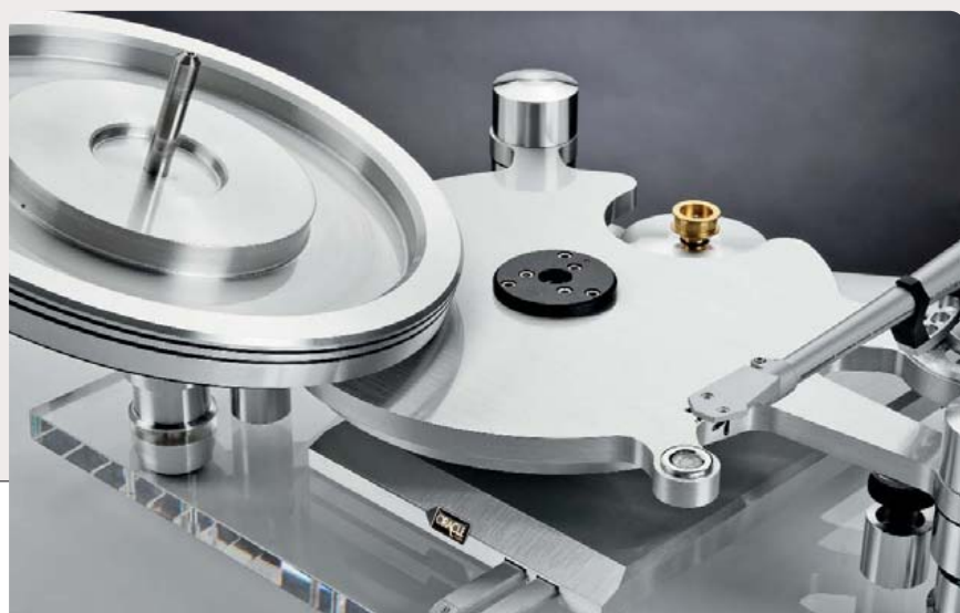
Smontando il piatto si accede al motore che altrimenti rimane seminascosto e questo layout permette di contenere la lunghezza della cinghia. Montate radialmente sul pozzetto (nero, al centro) ci sono le viti in nylon a testa emisferica che supportano la rotazione del perno. In testa al perno c'è incastonata la classica sfera di acciaio extraduro.
