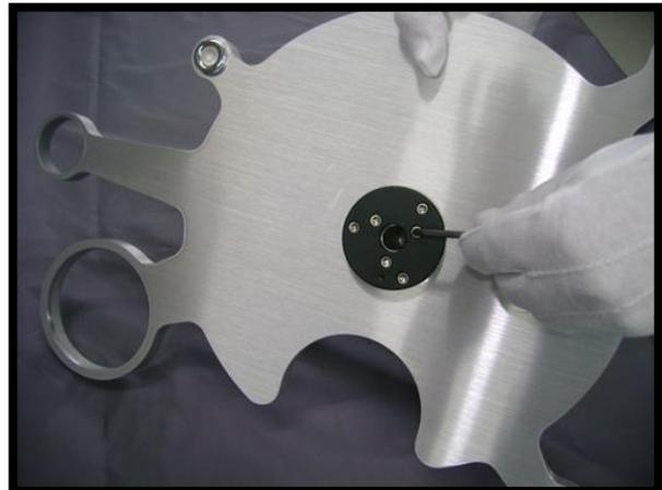
Assembler le support de l'axe de pivot au le sous-châssis
