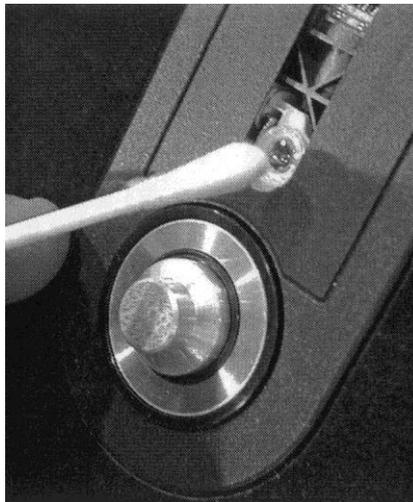
**Attention!** Assurez-vous qu'il n'y ait pas d'écoulement d'exédents d'alcool isopropylique à l'intérieur du mécanisme.
